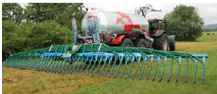
PHOTO 9/ Rampes à patins
